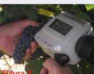
Figura 2, espectroscopia en uva sobre las cepas en fechas próximas a la vendimia para estimar azúcares, acidez y polifenoles. Estos trabajos, en general, han obtenido resultados aceptables en la estimación de sólidos solubles (R 2 =0.9), pero más discretos en la estimación de antocianinas, ácidos y polifenoles (Fuente: Blanco et al., 2009).
