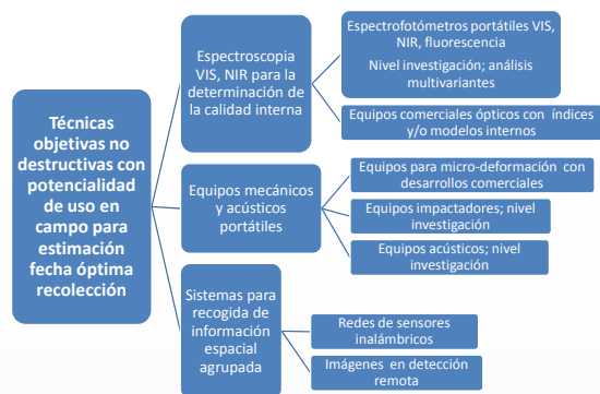
Esquema 1. Clasificación de las tecnologías existentes para determinación no destructiva de parámetros relacionados con la fecha óptima de recolección
